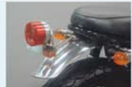
W-189 CEVタイプスクランブラーテールランプ ¥9,240 (税込) ステンレスパフ仕上げ 取り付けにはフェンダーへの穴あけ加工が 必要です。(リフレクター別途必要)
